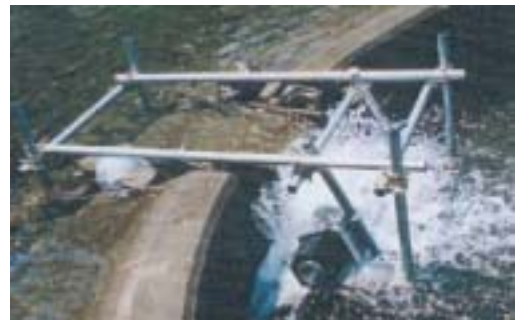
図4. 新潟ウオシントン(株)と共同開発しているサヴィヌス形水力発電機。設置が容易なためインシヤライズコストを大幅に削減することができる。
