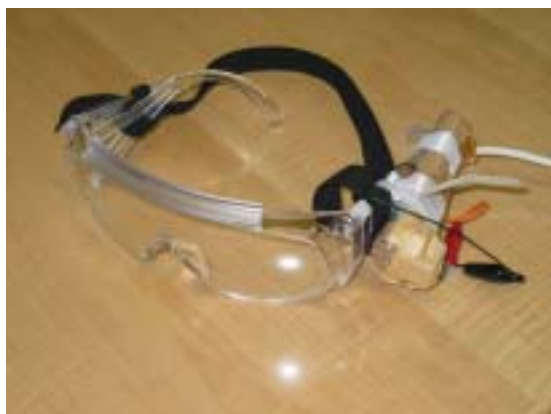
四肢麻痺者用入力装置試作機(レーザー光による指示)。 (東北大学との共同研究)
