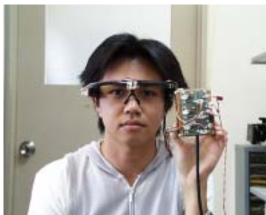
四肢麻痺者用入力装置試作機 (ジャイロによる頸部運動計測)。 (琉球大学との共同研究)
